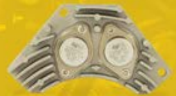
کنترل فن بخاری
